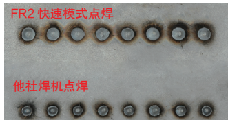
低碳钢 / 点焊 板厚 3mm，电流 160A，电压一元化 点焊时间：0.6 秒
