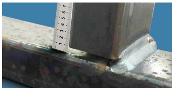
低碳钢 / 角接 板厚 2mm，电流 110A， 电压一元化 间隙 3mm，焊接速度 0.5m/min
